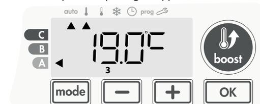
**Note :** Le témoin de chauffe s'affiche seulement si la température ambiante est inférieure à la température de consigne pré-réglée. Si la température ambiante est inférieure à la température de consigne de 2°C, alors la soufflerie s'enclenchera (voir paragraphe Super confort 10 pour plus de détails).
