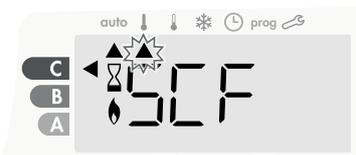
SCF et la température de consigne Super confort apparaissent sur l'afficheur alternativement.
