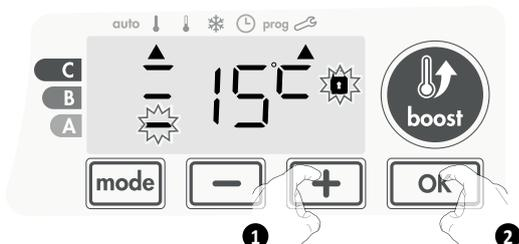
Si vous ne souhaitez pas la modifier, appuyez sur  : l'appareil vous propose automatiquement de régler la butée maximale. Pour sortir des réglages utilisateur, appuyez 2 fois sur .
