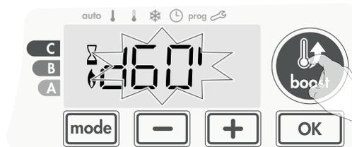
Durant la 1<sup>ère</sup> minute, vous avez la possibilité de modifier la durée du Boost de 0 à la durée maximale autorisée du Boost telle que définie lors des réglages utilisateur (voir page 21 pour plus de détails) par intervalle de 5 minutes (ou plus rapidement par appui supérieur à 2 secondes) par appui sur et . Cette modification sera sauvegardée et effective pour les prochains Boost.
